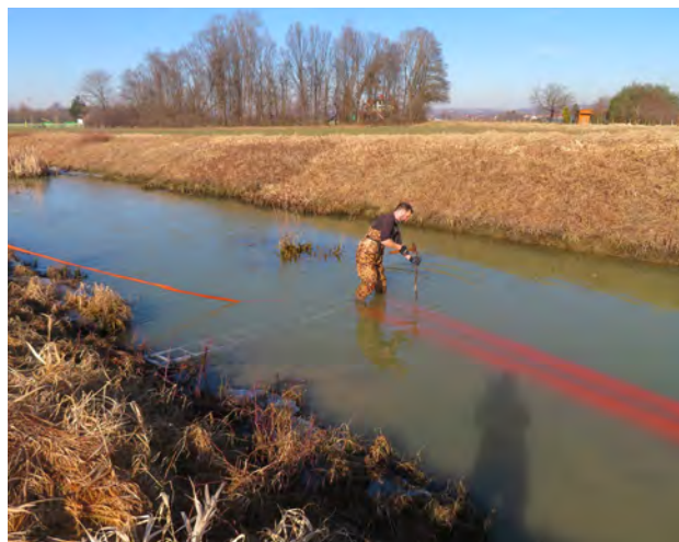
Sliki 137 in 138. Pritrditev kletke zagotovi, da ob večjih vodostajih ali pretoku kletka in cevi ostanejo na zelenem mestu.
