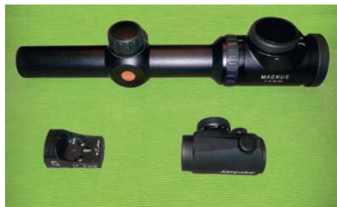
Tri najpogostejše različice »rdečih pik«: refleksni vizir, »rdeča pika« z zaprtim ohišjem ter širokokotni daljnogled 1–6,3 x 24.
